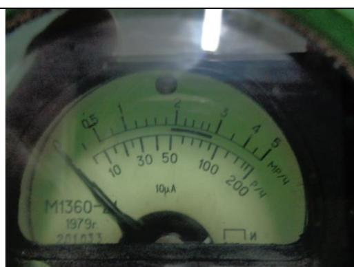
Рис. 11 Рентгенометр-радиометр ДП-5 В
