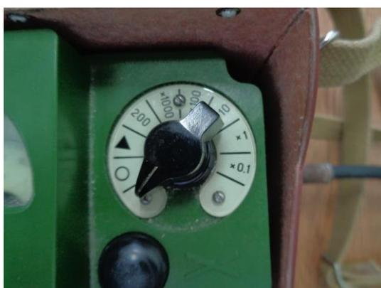
Рис. 13 Переключатель поддиапазонов ДП-5В
