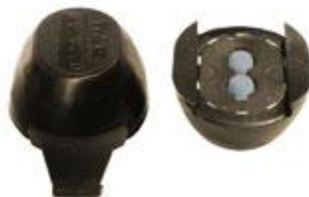
Рис.9 Дозиметр ТЛД 500К
