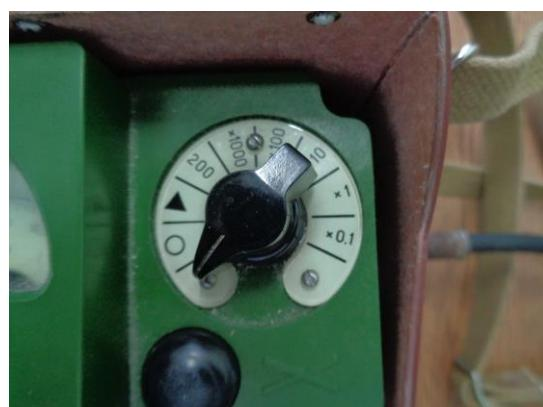
Рис. 13 Переключатель поддиапазонов ДП-5В
