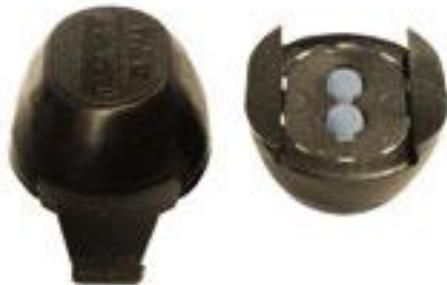
Рис.9 Дозиметр ТЛД 500К
