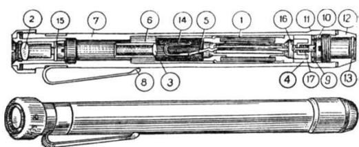
Рис. 4 Индивидуальный дозиметр ДКП-50
