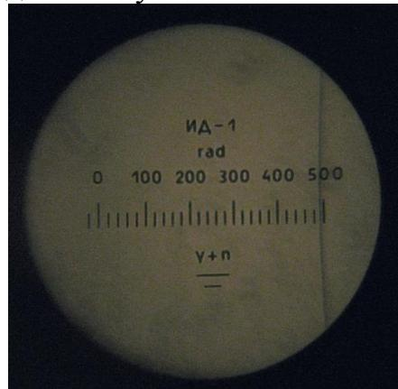
Рис. 7 Шкала дозиметра ИД-1
