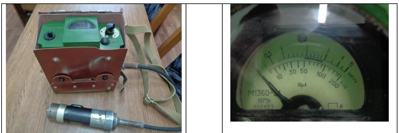
Рис. 11 Рентгенометр-радиометр ДП-5 В
