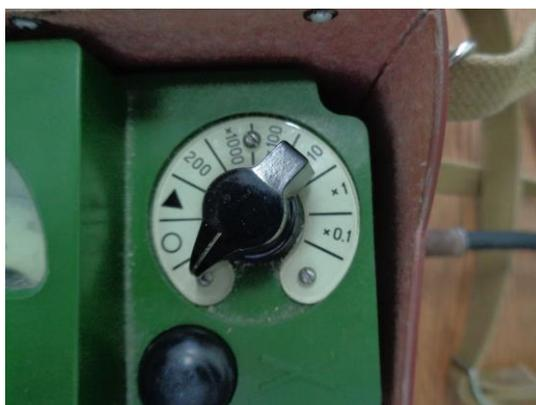
Рис. 13 Переключатель поддиапазонов ДП-5В
