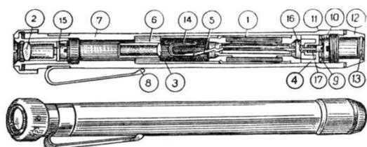
Рис. 4 Индивидуальный дозиметр ДКП-50
