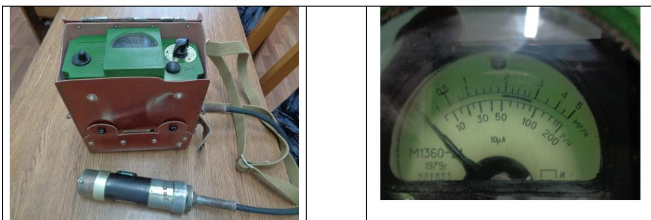
Рис. 11 Рентгенометр-радиометр ДП-5 В
