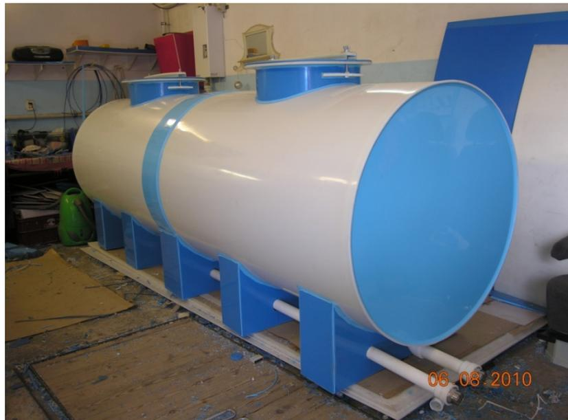
**Водоснабжение в ЧС обеспечивается путем создания запасов питьевой воды из расчета 2 л/сут. на больного (пострадавшего) и технической воды - по 10 л/сут. на койку. Аварийные емкости устанавливаются в верхней части здания или в отдельной водонапорной башне (бассейне). Предусматривается возможность подачи воды с помощью трубопроводов (гибких шлангов) от внешних сетей или подвижных средств с применением специальных присоединительных конструкций.**
