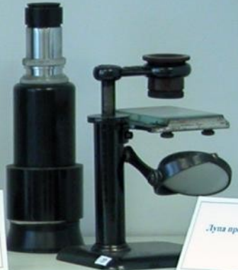
Лупа препаровальная Прибор служит для рассматривания препаратов натуральных объектов над лупой, увеличивающей в 10 раз
