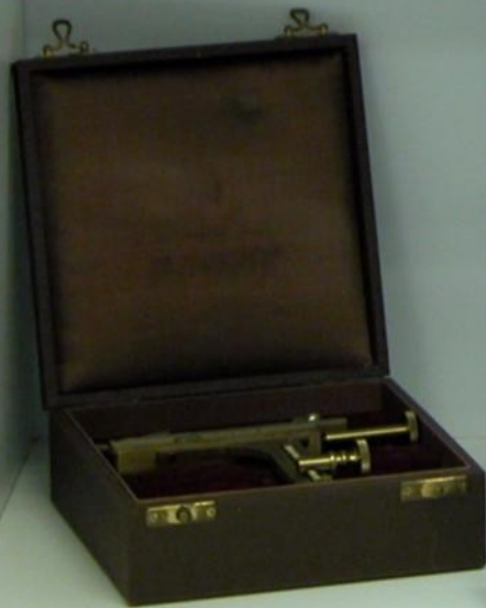
Поларизирующий микроскоп Предназначен для исследования кристаллических и жидкокристаллических веществ. Принцип действия микроскопа основан на эффекте двойного лучепреломления в кристаллическом объекте. В результате интерференции лучей образуются светлые интерференционные картины, позволяющие изучать пространственной ориентации молекул в изучаемом объекте.
